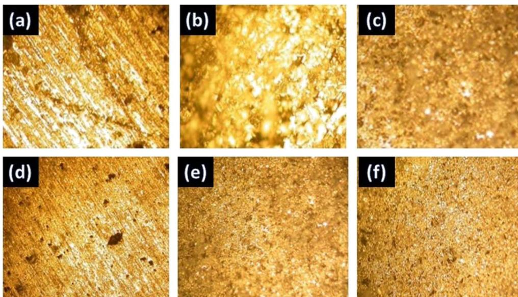
**Fig. 8.** Wear-tested MWCNT reinforced Al/MWCNT composites. (a) 620 C % 2,5 MWCNT, (b) 620 C % 5 MWCNT, (c) 620 C % 7,5 MWCNT, (d) 640 C % 2,5 MWCNT, (e) 640 C % 5 MWCNT, (f) 640 C % 7,5 MWCNT.
